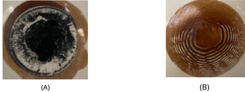
Şekil 1. Araştırılan koloidal dispersiyonların kuru damlaları ("kahve halkası etkisi"): (a) hümkik madde özütü; (B) asit özü . hümkik madde, (b) fulvik asit.
